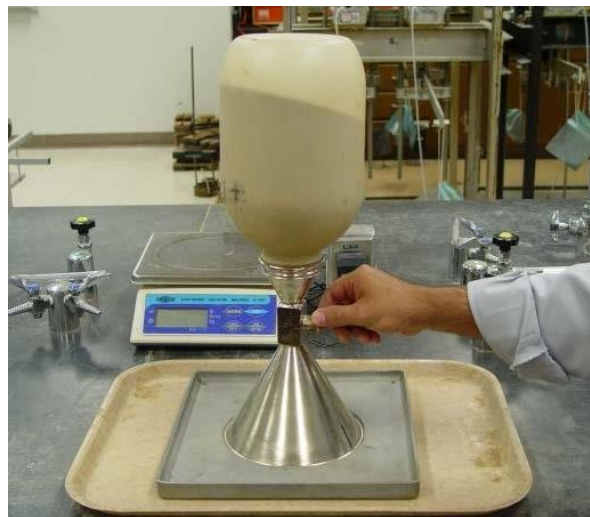
Figura 161A - 1. Determinación de la constante del cono
